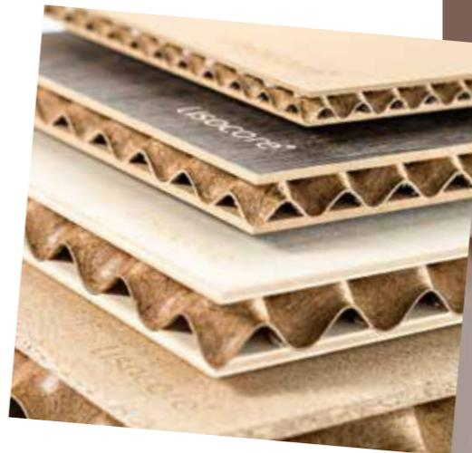
Der Yucon setzt auf innovative Leichtbaumaterialien: Beim Möbelbau wird der Hochleistungswerkstoff lisocore® eingesetzt
